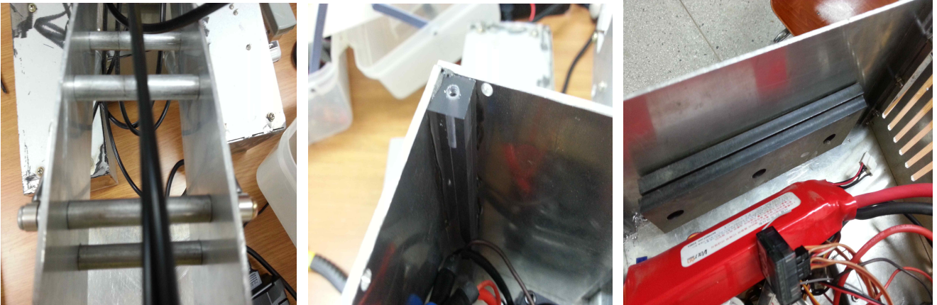
<환풍에 나사구멍을 뚫은 지지대> <아크릴 기둥을 이용한 벽구조> <무게중심을 위한 납덩어리 배치>
